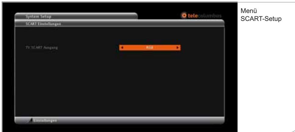
Sie gelangen auf die SCART-Einstellungen-Seite über das System Setup Sub-Menü durch Drücken der **<OK>**-Taste. Im SCART-Setup können die Einstellungen für den analogen Output vom Festplatten-Receiver für Röhrenfernseher und nicht-HDMI-fähige TV-Geräte festgelegt werden.
