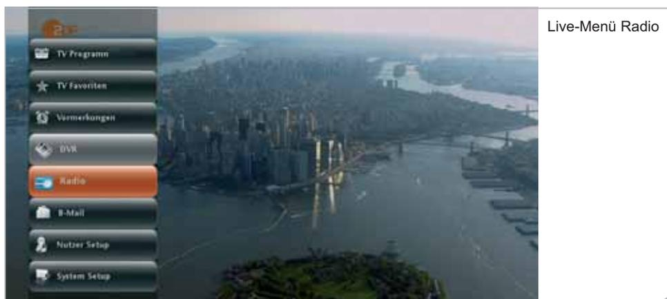
Falls Sie über das Live-Menü im TV-Modus auf den Radiomodus wechseln wollen, zeigt das Live-Fenster in der Übersicht die zuletzt gewählte TV-Sendung an. Erst nach Bestätigung des gewünschten Senders per **<OK>**-Taste wechselt das Gerät in den Radio-Modus.
