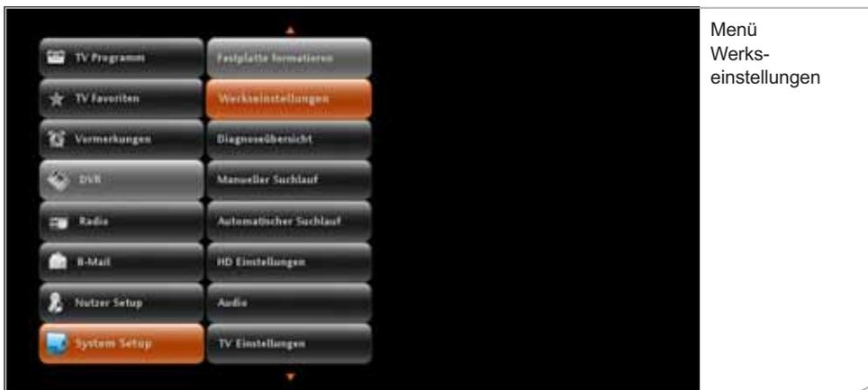
Danach werden Sie gefragt, ob Sie die Wiederherstellung der Werkseinstellungen wünschen. Bitte stimmen Sie durch Drücken der <OK>-Taste bei „Ja, weiter“ zu. Wenn Sie das Gerät nicht vollständig zurücksetzen möchten, wählen Sie „Nein, zurück“.
