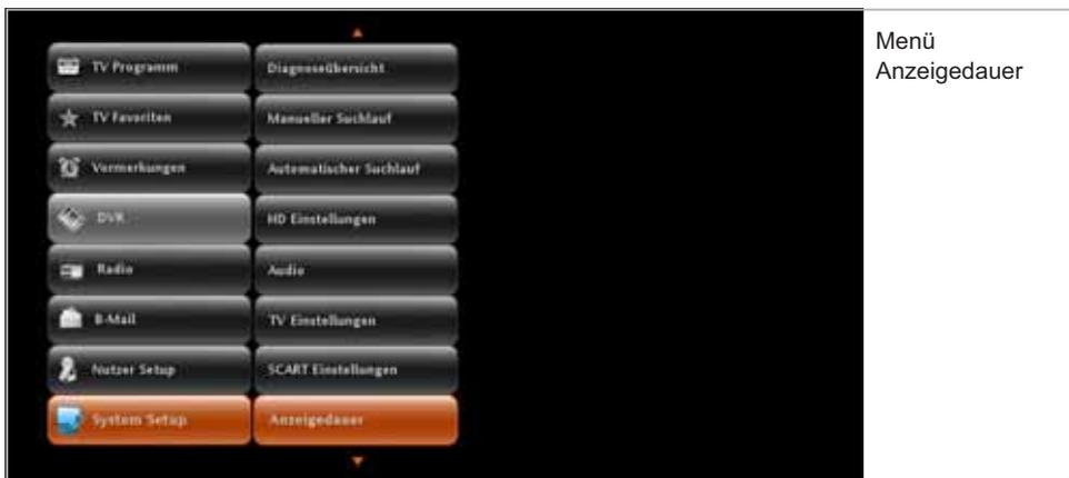
**Banner Anzeigedauer:** Das Infobanner wird bei jeder Umschaltung auf einen neuen Sender für standardmäßig zehn Sekunden angezeigt. Falls Sie eine längere Anzeigedauer wünschen, können Sie zwischen verschiedenen Anzeigedauer-Optionen von 10 bis x Sek. über die **<Links>**- und **<Rechts>**-Pfeiltasten wählen.
