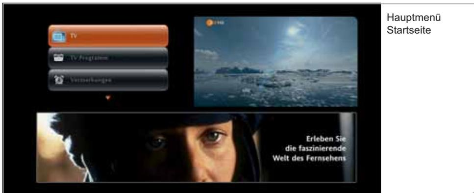
Die zuerst angezeigte Hauptmenü-Startseite zeigt links oben die Funktionsflächen, die Sie über die **<Oben>**- und **<Unten>**-Pfeiltasten anwählen und über **<OK>** auswählen können. Rechts oben wird das Fernseh-Live-Bild angezeigt und unten erscheint ein Informationsbanner. Zu einem späteren Zeitpunkt können hier die interaktiven Anwendungen ausgewählt werden.
