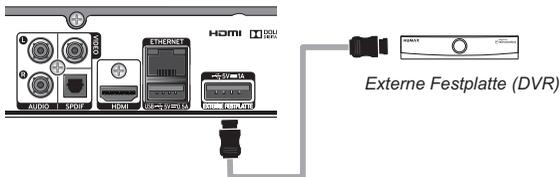
**HINWEIS:** Für die externe Festplatte ist kein zusätzliches Netzteil erforderlich. Das Gerät wird über das eSATA Kabel, das an den eSATA Anschluss an der Rückseite des Receivers angeschlossen ist, mit Strom versorgt.
